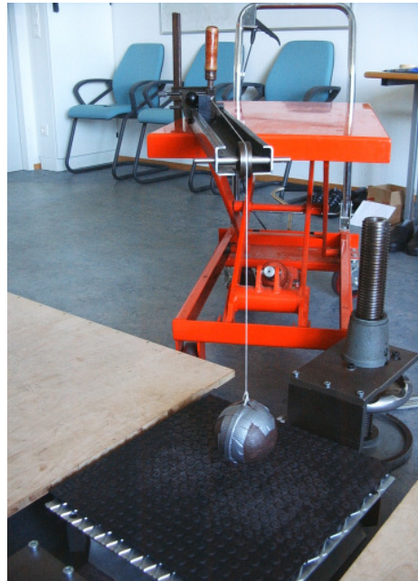
Abb. 2-4: Vorrichtung für den simulierten Fersenaufprall
